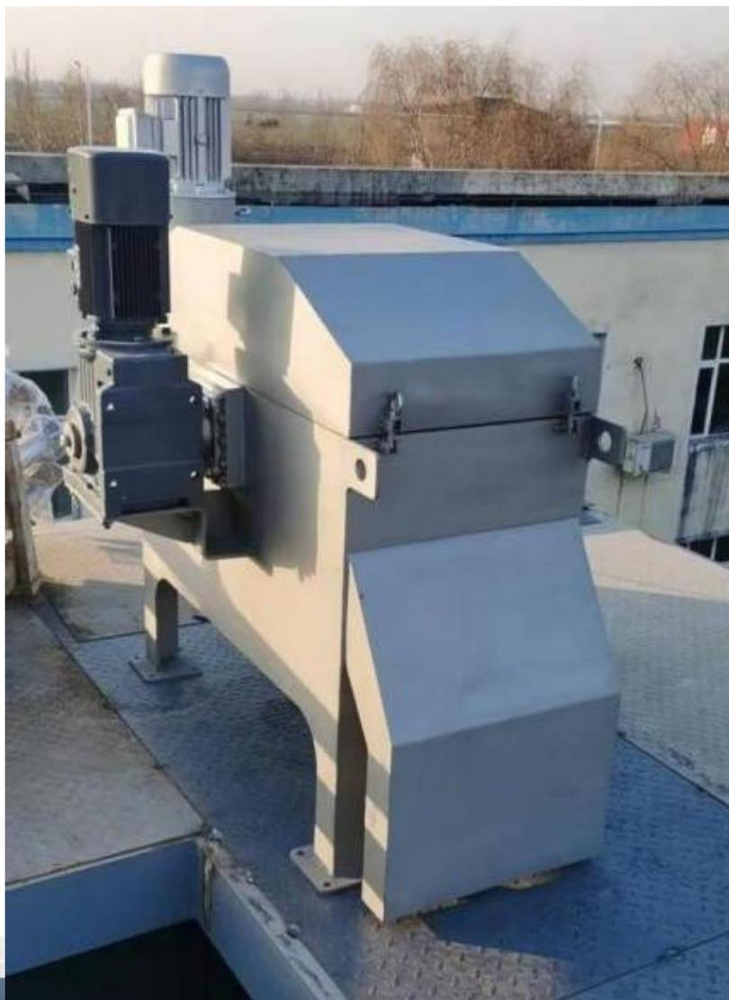
回流污泥经剩余污泥泵提升至高剪机。其功能是将混凝絮体重新分解，机器内部特殊的流道与机械结构产生强烈的剪切力，使得絮体中的磁粉成为自由状态，便于磁分离器回收磁粉，提高回收率。磁絮团经过高速剪切机破碎后进入磁分离器中，一方面将磁粉回收至反应池中进行循环使用。另一方面分离后的污泥排入污泥储池进行后续污泥脱水处理。
