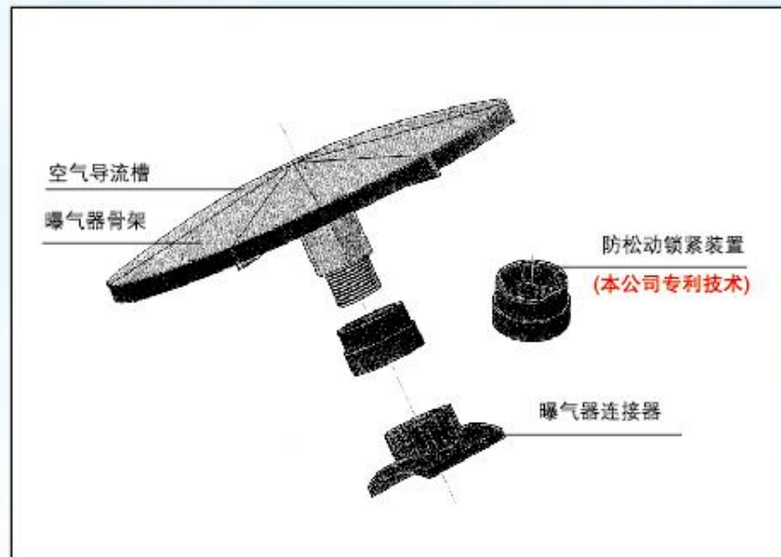
YHQW型空气导流球形微孔曝气器的结构示意图
