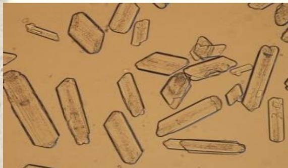
反应器排出硫酸钙显微照片
