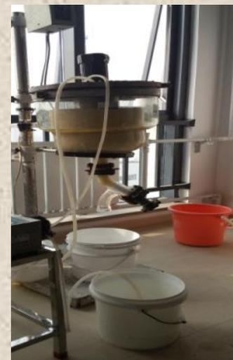
调控反应结晶沉锌，硫酸锌硫酸钠联产工艺
