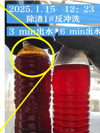
聚集除渣系统 反洗出水
