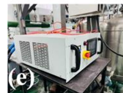
图7.31 (a) 中试现场电化学水处理系统；(b) 电化学反应器；(c) 传感器集成柜；(d) 终端工控机；(e) 程控电源；(f) 传感器测试槽；(g) 工控机运行界面
