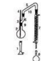
图 3-2-8 氟化物直接蒸馏装置 1—温度计；2—1L 烧瓶；3—接收器； 4—温度计；5—内径 12mm 的直接管； 6—连接管；7—冷凝器；8—100ml 量瓶； 9—ST2440 接头；10—ST2440 接头
